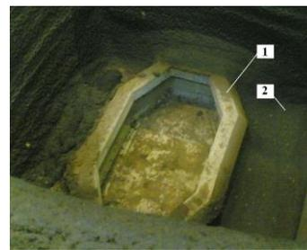
Рисунок 1. Компоновка металлоприёмника промежуточного ковша слябовой МНЛЗ в приёмной камере: металлоприёмник; приемная камера ковша
